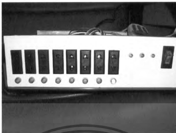
รูปที่ 5.13 ผลแสดงการทำงานออกเอาต์ 1 LED1 จะสว่าง
