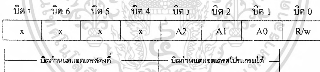
รูปที่ 2.13 รูปแบบของข้อมูลกำหนดแอดเดรสที่ใช้ในการอ้างถึงแบบ 7 บิต
