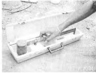
รูปที่ 3.28. แสดงเครื่องมือการทดสอบหาค่าความหนาแน่น
