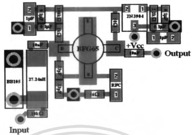
รูปที่ 3.18 ลายวงจรของวงจรกำเนิดสัญญาณแบบปรับค่าความถี่ได้ตามแรงดันไฟฟ้า
