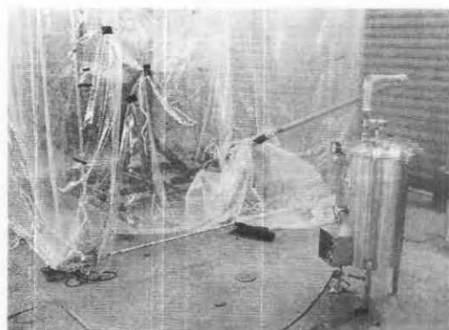
รูปที่ 4.16 ก) เครื่องกำเนิดไอน้ำ ข) การวางท่อจ่ายไอน้ำ
