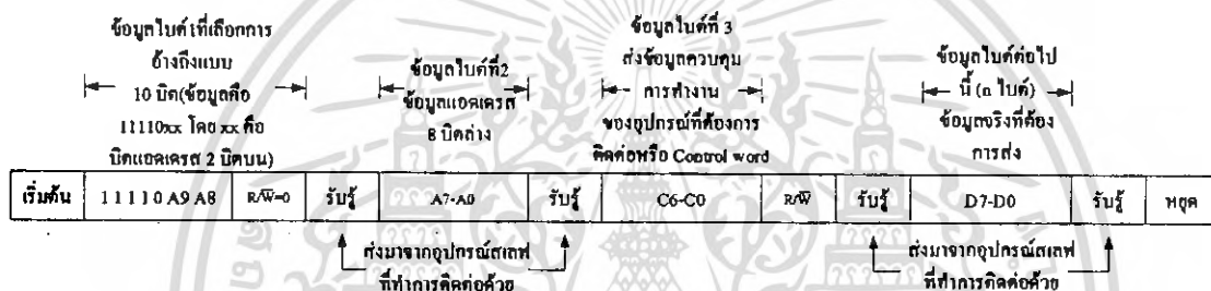
รูปที่ 2.19 รูปแบบของข้อมูลในการอ้างแอดเดรสแบบ 10 บิตบนระบบบัส I 2 C
