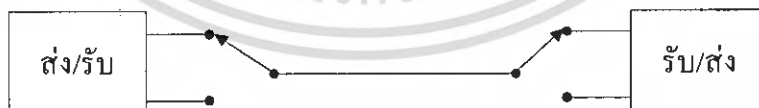
รูปที่ 2.15 แสดงการสื่อสารแบบฮาล์ฟดูเพล็กซ์
