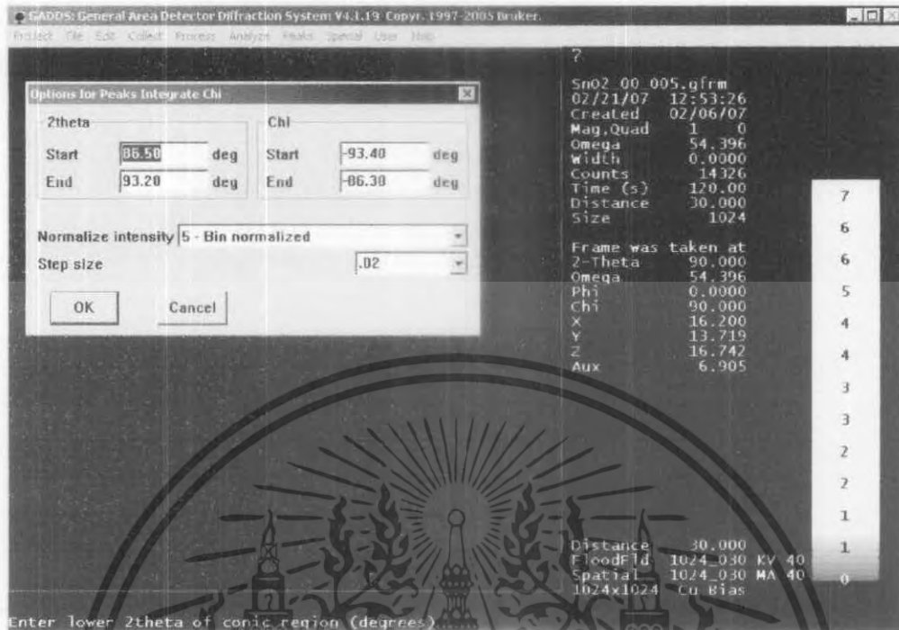
รูปที่ 4.37 แสดงภาพก่อนการ Integrate ของ Tin Oxide ( มุมระหว่าง 80.4 – 99.4 )
