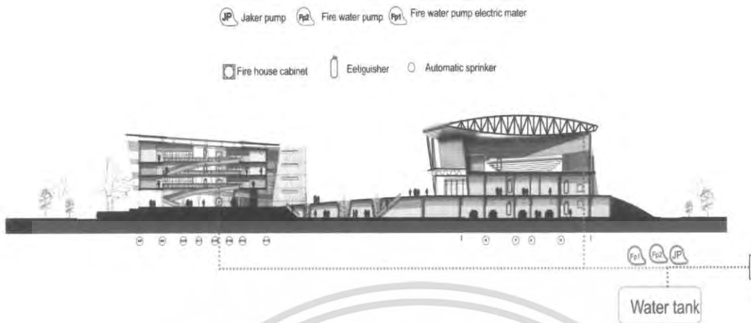
ภาพที่ 3.13 Diagram ระบบดับเพลิงของอาคารกิจกรรมนักศึกษาและ ปฏิบัติการณ์ไฟ
