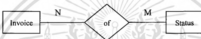
ภาพที่ 33 แสดงความสัมพันธ์ระหว่างเอนทิตี Invoice และเอนทิตี Status
