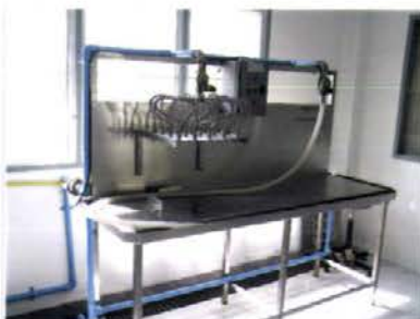
ภาพที่ 55 แท่นบรรจุ ที่ประกอบด้วย หัวบรรจุขนาด 500 มิลลิลิตร และ หัวบรรจุถังขนาด 18.9 ลิตร
