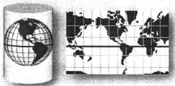
รูปที่ 2.13 เส้นโครงแผนที่แบบเมอร์เคเตอร์
