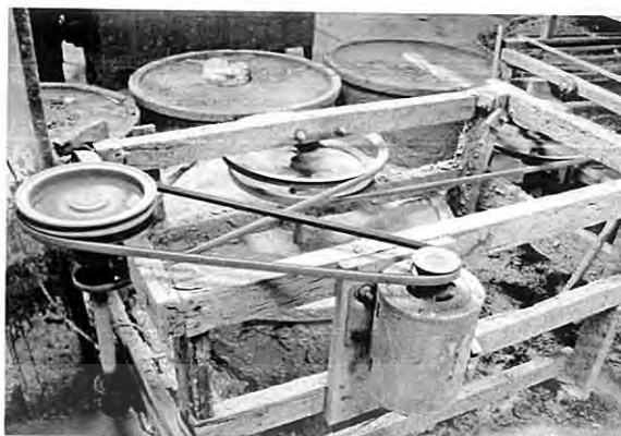
ภาพที่ 5 เครื่องนวดดินที่ใช้มอเตอร์ไฟฟ้า ที่มา: (กลุ่มหัตถกรรมเครื่องปั้นดินเผาเกาะเกร็ด หมู่ 1)
