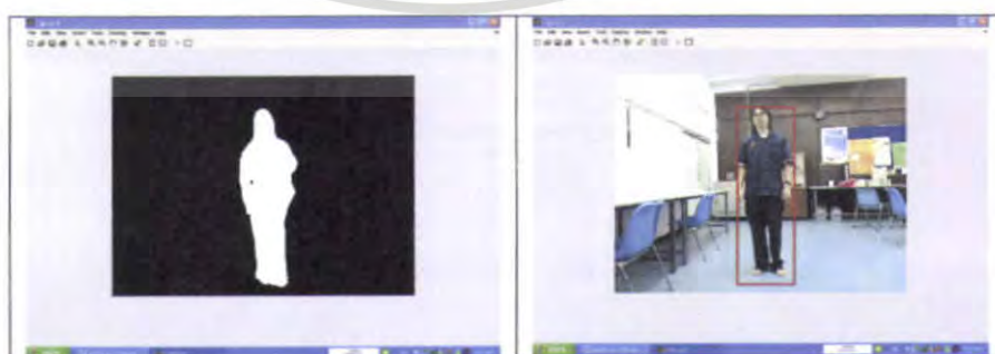
ภาพที่ 4.6 ผลลัพธ์ที่ได้จากการตีกรอบเพื่อระบุตำแหน่งของวัตถุ
