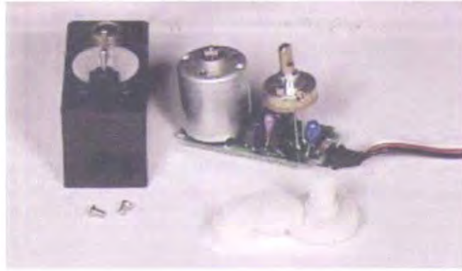
ภาพที่ 3.6 แสดงส่วนประกอบภายในของเซอร์โวมอเตอร์
