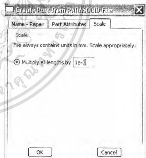
รูปที่ 7-5 ขั้นตอนการเปลี่ยนหน่วยจาก มิลลิเมตร เป็น เมตร
