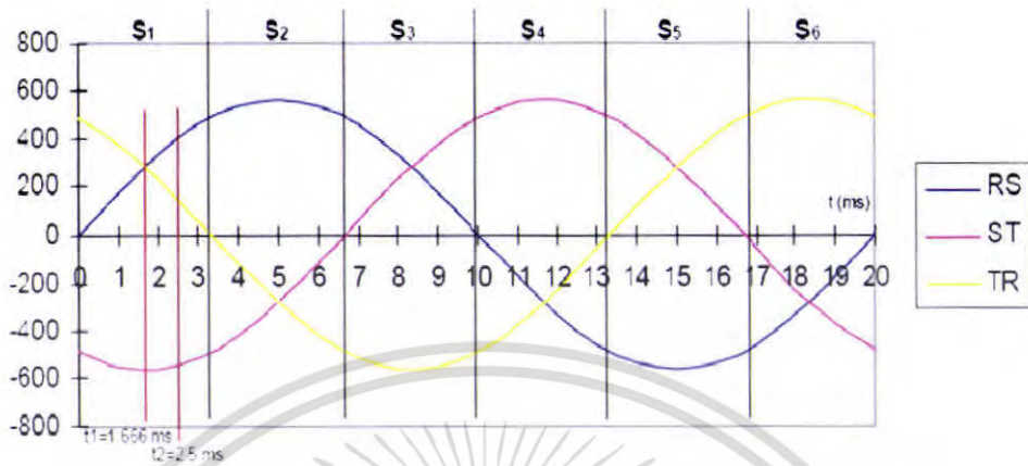
รูปที่ 3.14 สัญญาณ sine wave ที่ป้อนให้กับมอเตอร์
