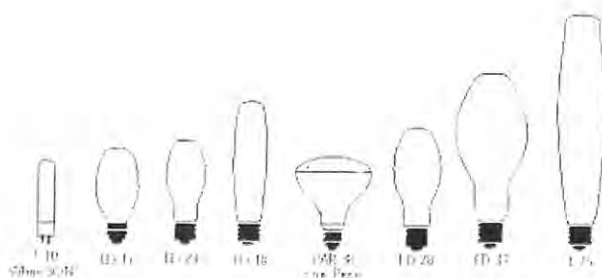
ภาพที่ 2.34 แสดงลักษณะหลอดโซเดียมความดันไอสูงแบบต่างๆ
