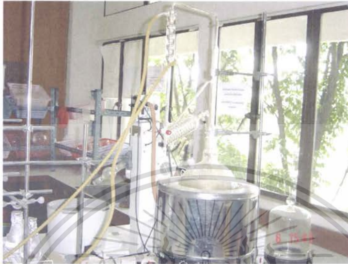
ภาพที่ 3 การสกัดน้ำมันหอมระเหยด้วยชุดเครื่องกลั่นแก้ขนาดมาตรฐาน
