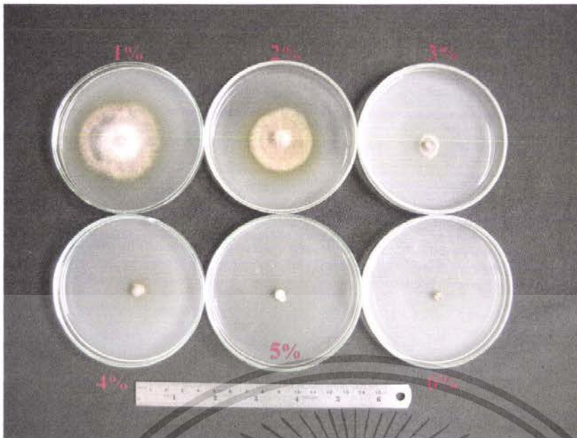
รูปที่ 12 ผลของเอทานอลที่ความเข้มข้นร้อยละ 1, 2, 3, 4, 5 และ 6 ต่อการเจริญเติบโตของเชื้อรา Alternaria solani
