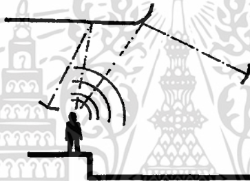
ภาพประกอบที่ 2.42 ลักษณะ โครงสร้างที่มีผลต่อการสะท้อนของเสียง
