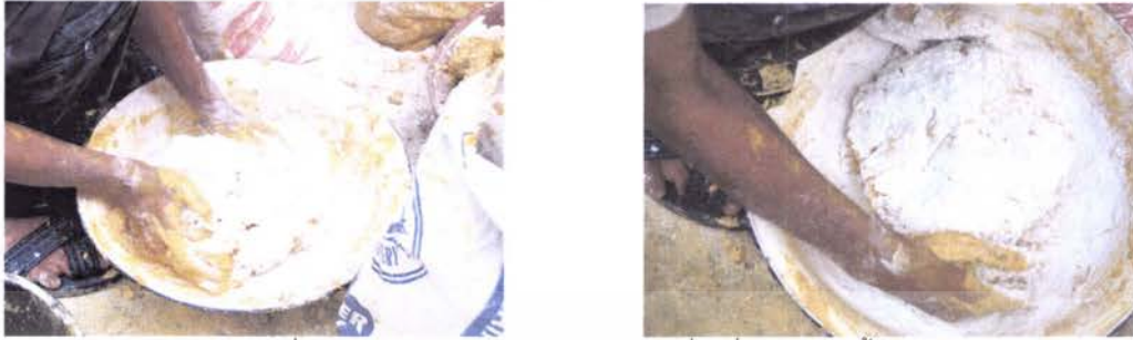
รูปที่ 41 การผสมปูนพลาสเตอร์และยิปซัมเพื่อใช้ในการปั้น
