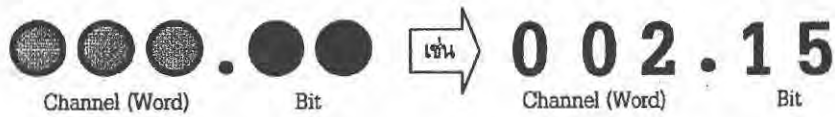
รูปที่ 7.7 การกำหนดแอสแตรสให้กับอินพุต/เอาต์พุตของพีแอลซีโดยใช้ตัวเลข 5 ตัว
