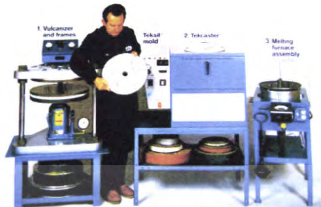
รูปที่ 123 เครื่องมือ อุปกรณ์ สำหรับหล่อเหรียญ
