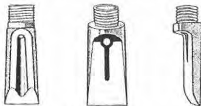
รูปที่ 2.12 หัวเจาะโดยใช้น้ำพ่นลักษณะต่าง ๆ (Jetting drill bits)
