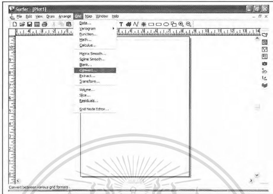
รูปที่ 3.31 แสดงขั้นตอนการแปลงพิกัดที่ได้เป็นเส้นชั้นความสูงโดยผ่านโปรแกรม Surfer โดยเลือกเมนู Grid คำสั่ง Convert
