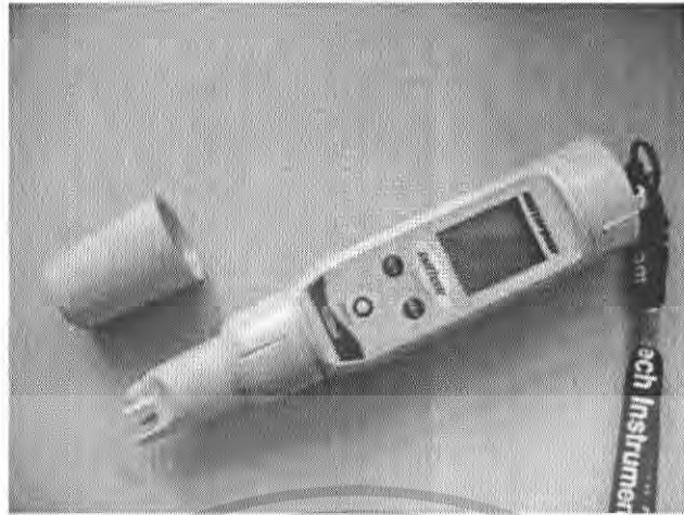
รูปที่ 3.12 การวัดค่าความเค็มด้วยเครื่อง ยี่ห้อ EUTECH SaltTestr
