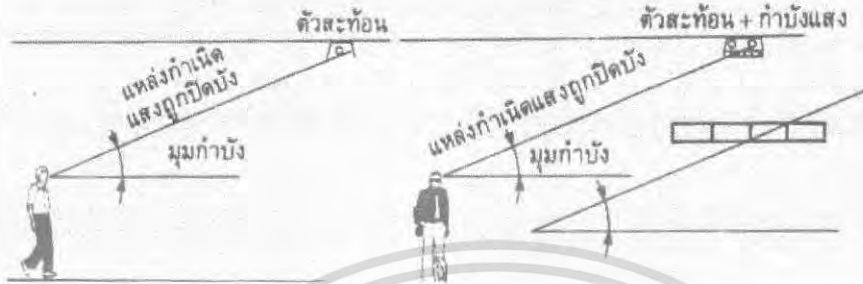
ภาพประกอบ 2-89 แสดงการควบคุมแสงจ้าโดยมุมกําบัง
