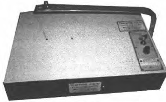
รูปที่ 2.18 ภาพอุปกรณ์ตัดไหมที่ตัดด้วยลวดความร้อนแบบมีแท่นตัด และปรับอุณหภูมิได้ใช้ไฟบ้าน AC 220 โวลต์ ยี่ห้อ CONNORDE ที่มา : เพิ่มภาพส่วนบุคคล นาย ภักดิ์ฉมน์ ฉันทสวัสดิ์ พ.ศ. 2550
