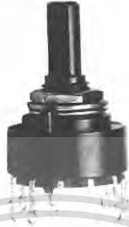
รูปที่ 2.38 ภาพสวิตช์แบบหมุน
