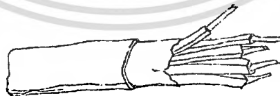
รูปที่ 2.42 แสดงสายไฟสำหรับเครื่องกลหนัก
