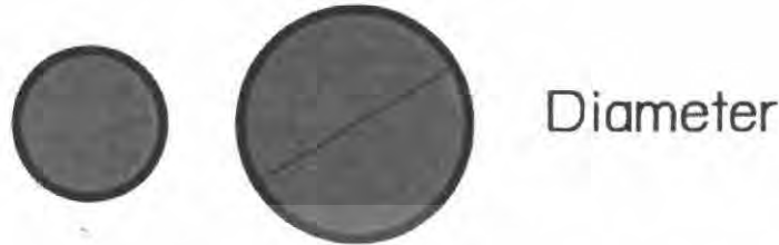
รูปที่ 2.31 ภาพแสดงปริมาณความร้อนแปรตามพื้นที่หน้าตัดของเส้นลวด ที่มา : แฟ้มภาพส่วนบุคคล นายภักดิ์วัฒน์ อินทสวัสดิ์ 2550
