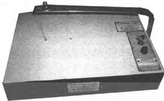
รูปที่ 2.19 ภาพเครื่องตัดไฟมที่ตัดด้วยลวดความร้อนแบบมีแท่นตัด และปรับอุณหภูมิได้ใช้ไฟบ้าน AC 220 โวลต์ ยี่ห้อ CONNORDE ที่มา : แฟ้มภาพส่วนบุคคล นาย ภักดิ์ธนา จันทร์สวัสดิ์ พ.ศ. 2550
