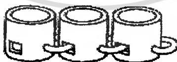
ภาพที่ 85 แสดงการยึดชิ้นงานแบบขดลวดตัวยู
