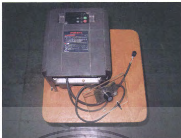
รูปที่ 4.5 ชุดควบคุมความเร็วรอบ (Inverter)
