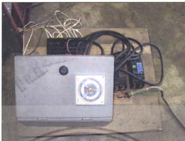
รูปที่ 4.7 ตัวควบคุมอุณหภูมิชุดให้ความร้อน
