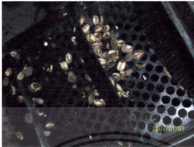
รูปที่ 4.4 สภาพเปลือกผลที่ออกไปยังช่องทางออกของเปลือกผล
