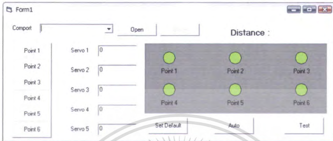
รูปที่ 3.19 แสดงหน้าต่างการควบคุมแขนกลของโปรแกรมวิชวลเบสิก
