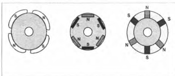
รูปที่ 2.4 แสดงภาพตัดโรเตอร์ของบรัชเลสดีซีมอเตอร์
