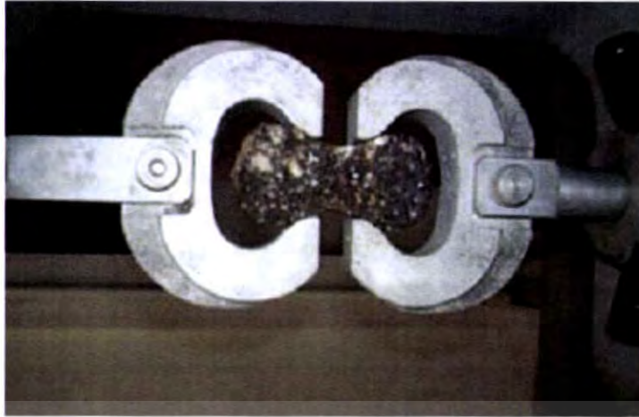
รูปที่ 4.11 แสดงการทดสอบกำลังรับแรงดึงของก้อนแอสฟัลต์
