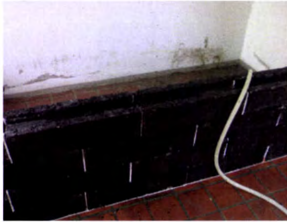
รูปที่ 3.16 แสดงการทดสอบการซึมผ่านของก๊อนแอสฟัลต์ (1 ชั้น) (มีโฟมอุดช่วงข้อต่อ) ในบ่อทดสอบ
