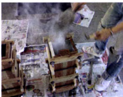
รูปที่ 3.9 นำแอสฟัลต์เทลงแบบหล่อแล้วกระทิ้ง 5 ชั้นชั้นละ 35 ครั้ง
