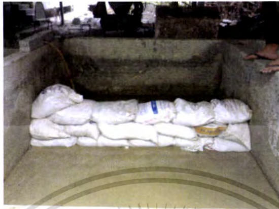
รูปที่ 3.13 แสดงการทดสอบการซึมผ่านน้ำผ่านของกระสอบทราย (1 ชั้น) ในบ่อทดสอบ
