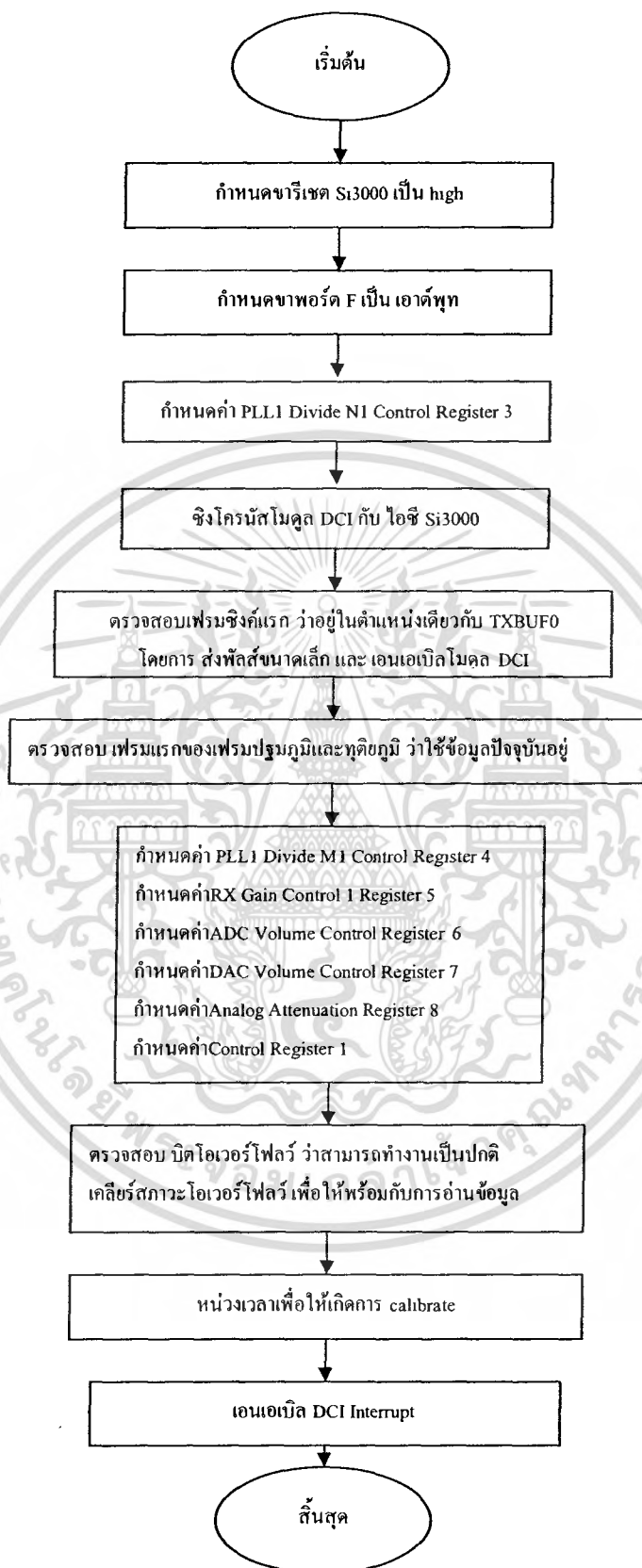
รูปที่ 3.13 แผนผังการทำงาน ของฟังก์ชัน Init_Si3000()
