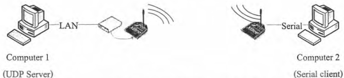
รูปที่ 4.14 การทดลองการรับส่งข้อมูลผ่านทางโปรโตคอล TCP/IP ไปยังโมดูล ZigBee
