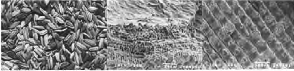
รูปที่ 2.2 ภาพถ่ายจากกล้องจุลทรรศน์แสดงพื้นผิวที่มีลักษณะคล้ายข้าวโพด และภาคตัดขวางแสดงโครงสร้างที่มีความพรุนสูง [6]
