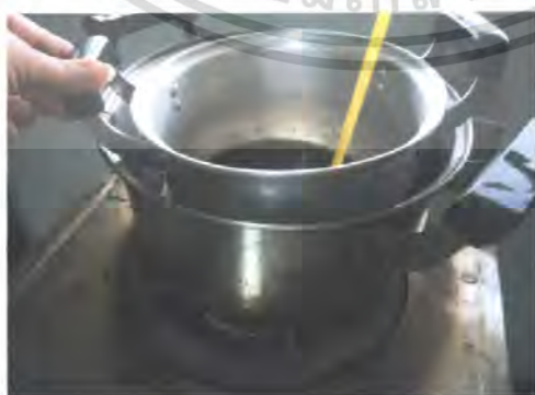
ภาพที่ 5 การพาสเจอร์ไรส์ด้วยการให้ความร้อนแบบ indirect heat โดยการใช้หม้อต้มแบบ 2 ชั้น
