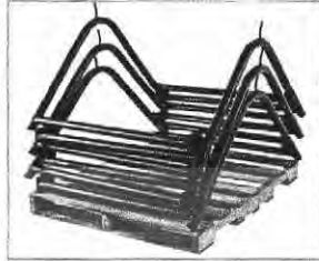
ภาพที่ 85: การซ้อนทับของชิ้นงาน เพื่อประหยัดพื้นที่ในการขนส่ง ที่มา : [Online]. เข้าถึงได้จาก : www.gilmorekramer.com
