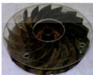
ค. ใบที่ 3 แบบโค้งงอไปด้านหลัง ติดใบพรุน 16 ใบ ปิดด้านบน
