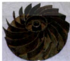
ข. ใบที่ 2 แบบโค้งงอไปด้านหลัง ติดใบพวน 16 ใบ
