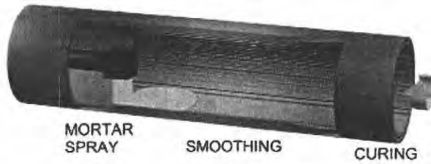
รูปภาพที่ 5.23 แสดงการเคลือบด้วยซีเมนต์
