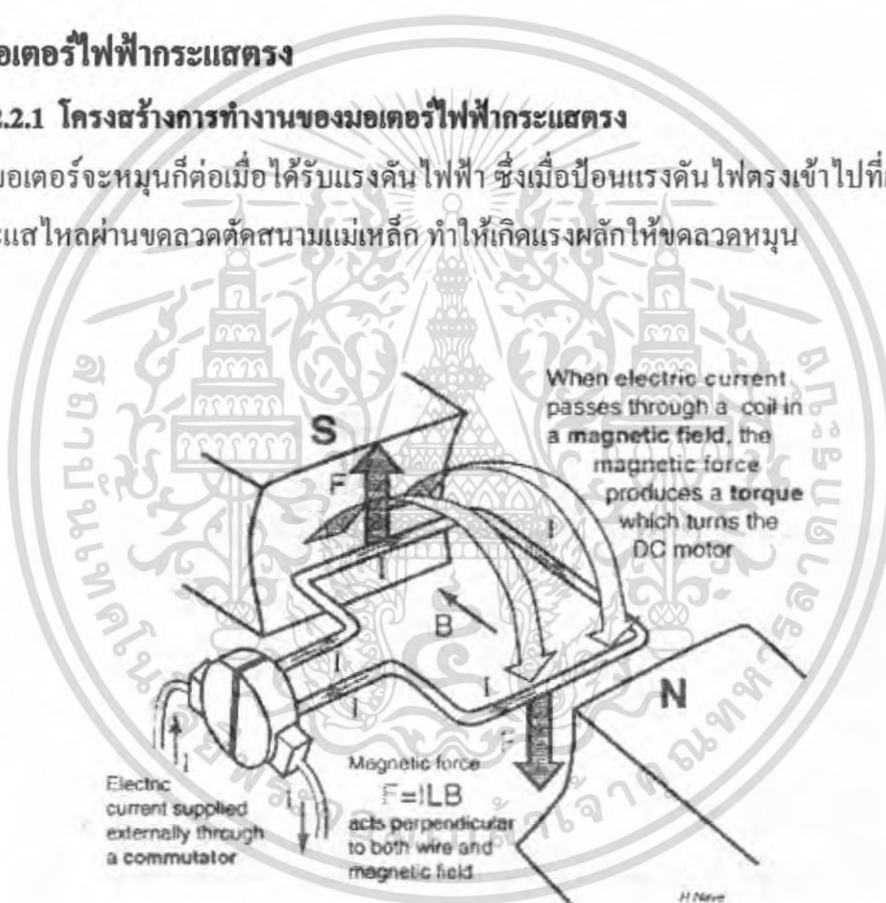
รูปที่ 2.8 การทำงานเบื้องต้นของมอเตอร์
