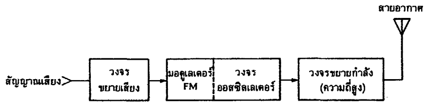
รูปที่ 2.2 แผนผังเครื่องส่ง FM อย่างง่าย
