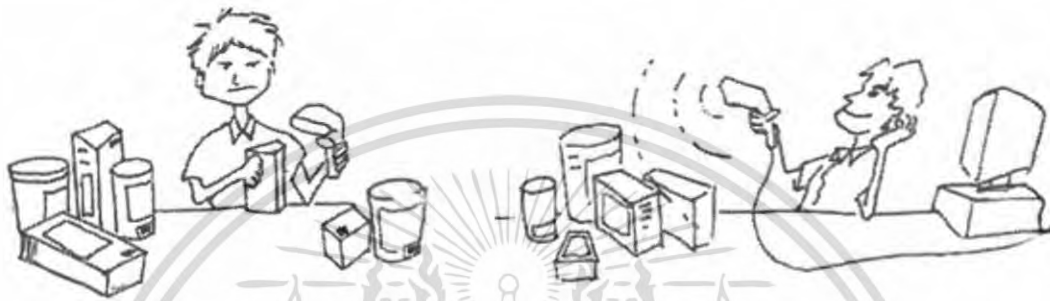
รูปที่ 2.18 การอ่านลากสินค้า (ซ้าย) ใช้รหัสแท่งอ่านได้ที่ละชั้น (ขวา) ใช้อาร์เอฟไอดีอ่านได้ที่หลายชั้น
