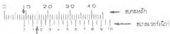
รูปที่ 5 แสดง ค่าจากสเกลหลัก + ค่าจากสเกลเวอร์เนีย
