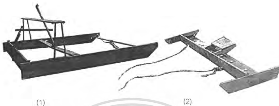
ภาพที่ 3 อุปกรณ์ปรับระดับดินพวงรูดไถเดินตามแบบควบคุมด้วยมือ (1) และแบบควบคุมด้วยเท้า (2)
