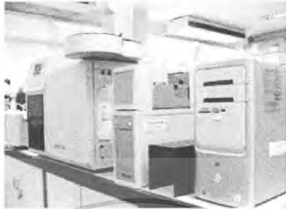
รูปที่ 3.11 Thermal desorption-GC-FID
