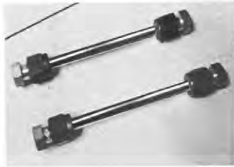
รูปที่ 3.5 Sorbent Tube ที่ใช้เก็บตัวอย่างอากาศปิดด้วย Swalog knut
