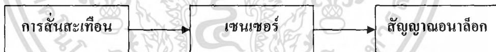
รูป 4.8 บล็อกไดอะแกรมเปลี่ยนการสั่นสะเทือนเป็นสัญญาณอนาล็อก
