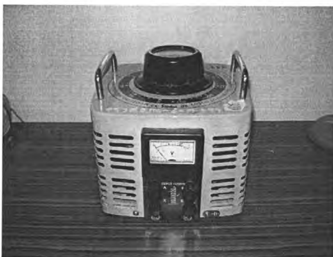
รูปที่ 3.26 หม้อแปลงปรับขึ้นแรงดัน
