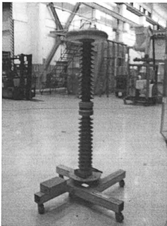
รูปที่ 3.22 โวลต์เตจดีไวเดอร์สำหรับแรงดันไฟฟ้ากระแสสลับ
