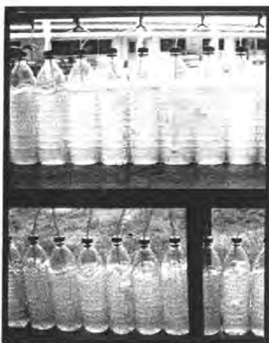
ภาพที่ 3 การเซ็ทขวดที่มีชุดควบคุม ชุดโพรไบโอติก ชุดแบคทีเรียนิวแบค และชุดแบคทีเรีย บาซิลลัสที่ความเข้มข้น 20, 40 และ 60 มิลลิกรัม/ลิตร จำนวน 30 ขวด
