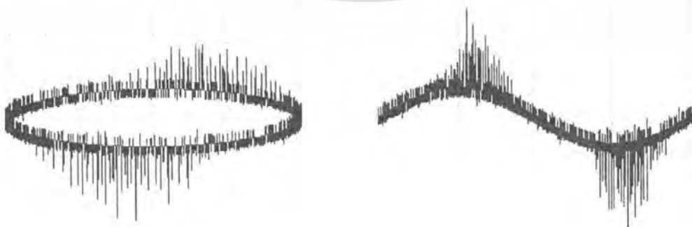
รูปที่ 4-12 PD เริ่มเกิดบนรูปคลื่นอิลิปส์และคลื่นไซน์ ที่แรงดัน 4.35 kV ค่าดิสชาร์จ 14.42 pC ที่มุม 90-150 องศาและมุม 270-320 องศา
