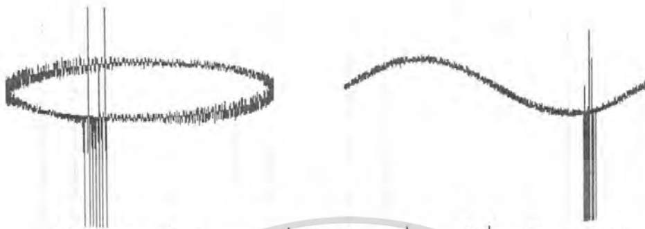
รูปที่ 4-10 PD เริ่มเกิดบนรูปคลื่นอิลิปส์และคลื่นไซน์ ที่แรงดัน 4.83 kV ค่าดิสชาร์จ 9.45 pC ที่มุม 300-320 องศา
