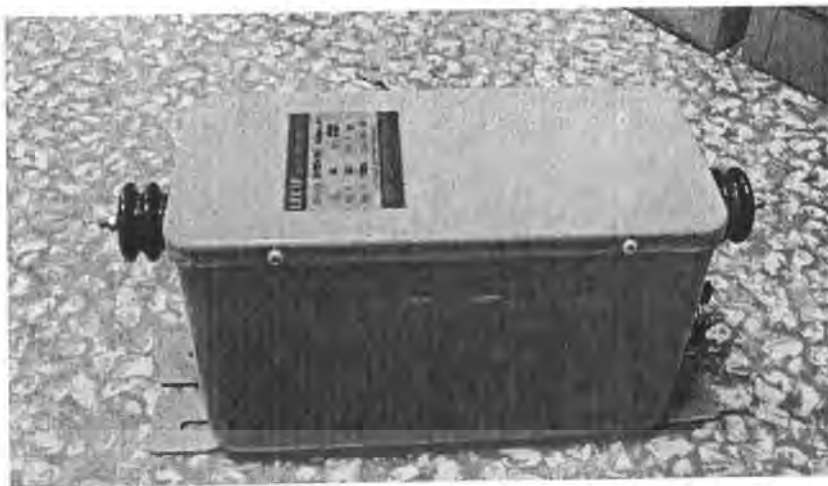
รูปที่ 4-28 หม้อแปลงทดสอบ พิกัด 230/15000 V
