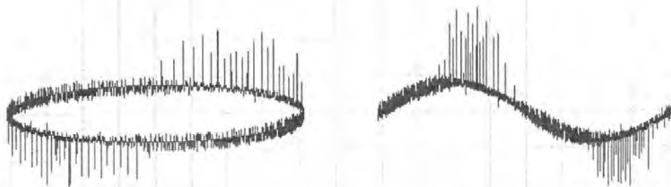
รูปที่ 4-16 PD เริ่มเกิดบนรูปคลื่นอิลิปส์และคลื่นซายน์ ที่แรงดัน 3.19 kV ค่าดิสชาร์จ 8.47 pC ที่มุม 90-150 องศาและมุม 270-320 องศา
