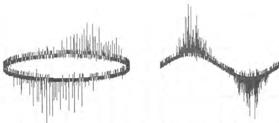
รูปที่ 4-13 PD เกิดบนรูปคลื่นอิลิปส์และคลื่นซายน์ ที่แรงดัน 6.48 kV ค่าดิสชาร์จ 61.62 pC ที่มุม 70-160 องศาและมุม 240-330 องศา
