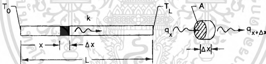
รูปที่ 2.12 การถ่ายเทความร้อนโดยการนำในแท่งโลหะ
